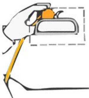
Hierfür suchen Sie einen geeigneten Ort für den Sensor aus. Bewährt hat sich eine Positionierung hinter dem Rückspiegel. Bei Fahrzeugen mit gegengleich arbeitenden Wischern empfiehlt sich ein Platz am Rand der Scheibe, jedoch im Wischerbereich, so dass ein Wischerarm drüber geht.
